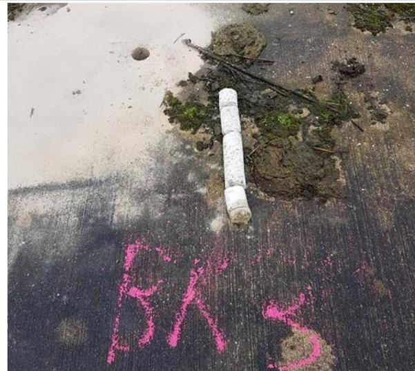
Abbildung 14: Betonkern Abschussplattform Betonfläche 2 (Blickrichtung NO)
