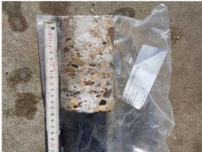
Abbildung 22: BK 4; Halle bei Betonfläche 2
